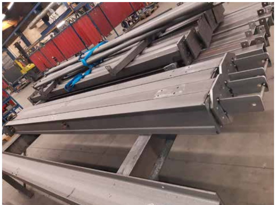
Die ersten Stahlträger sind produziert und liegen zur Weiterverarbeitung auf dem Firmengelände von Brüninghoff bereit. Quelle: Brüninghoff GmbH & Co.KG
